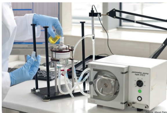
Rys. 4. Stanowisko pomiarowe do wyznaczania odporności rękawic ochronnych na przenikanie ciekłych substancji chemicznych metodą konduktometryczną w układzie zamkniętym wg normy PN-EN 16523-1+A1:2018-11 w ujęciu rzeczywistym (fot. Marek Pabis)
