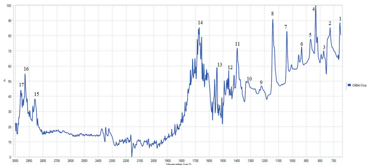
Rys. 3. Spektrum absorbcyjne FT-IR dla klopyralidu oktylobetainy
