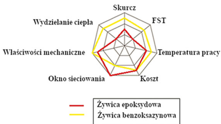
Ryc. 6. Porównanie właściwości żywic benzoksazynowych i epoksydowych
