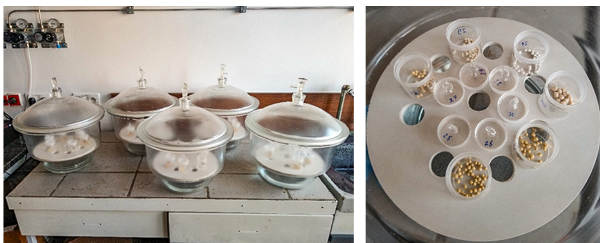
Ryc. 7. Eksykatory podczas badania higroskopijności próbek nawozów
