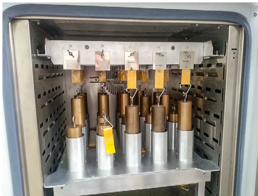
Ryc. 7. Pomiar adhezji zgodnie z normą FTM 9
