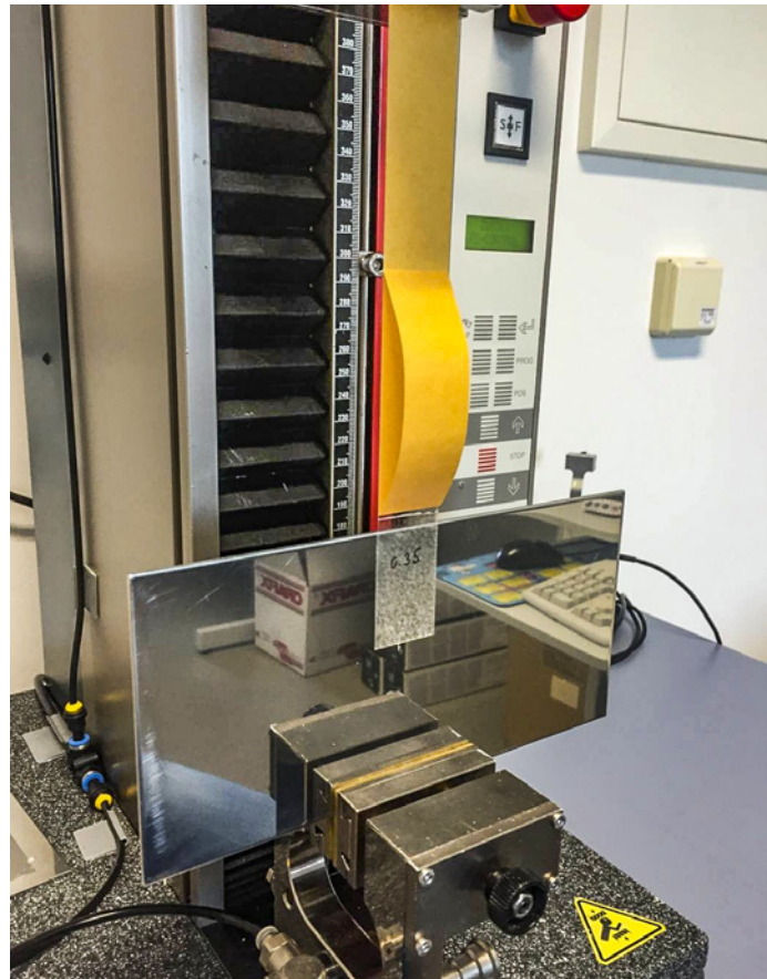
Ryc. 3. Pomiar kleistości zgodnie z normą FINAT FTM 1
