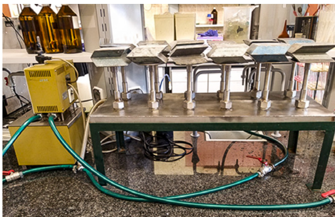
Ryc. 1. Aparat do badania tendencji do zbrylania wraz z przedstawionym schematem komory do termostatowania próbek nawozów
