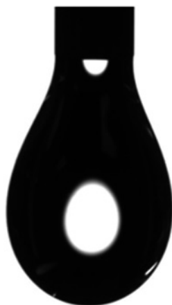
Ryc. 3. Obraz kształtu kropli wypływającej z kapilary
