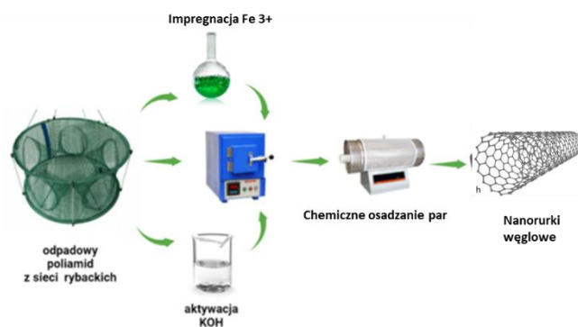
Rys. 1. Proces wytwarzania nanomateriału
