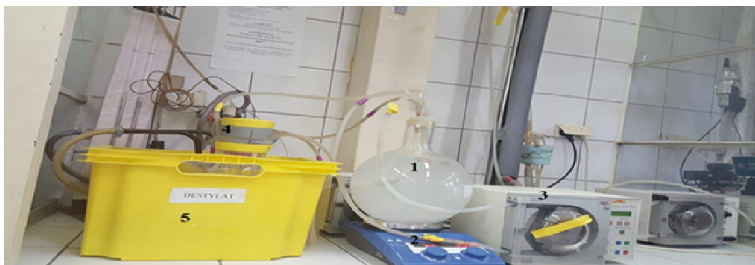
Rys. 1. Instalacja do destylacji membranowej (MD): 1 – zbiornik nadawy z zanurzonymi modułami membranowymi, 2 – płyta grzewcza z mieszadłem, 3 – pompa perystaltyczna, 4,5 – zbiornik destylatu wraz z chłodnicą (źródło własne)
