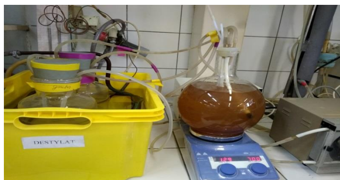
Rys. 1. Instalacja destylacji membranowej (MD): 1 – zbiornik nadawy z zanurzonymi modułami membranowymi, 2 – płyta grzewcza z mieszaniem, 3 – pompa perystaltyczna, 4, 5 – zbiornik destylatu wraz z chłodnicą
