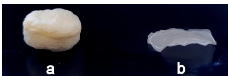
Rys. 1. Porównanie modyfikowanej i natywnej celulozy bakteryjnej; a – sucha celuloza modyfikowana kwasem cytrynowym w obecności katalizatora, b – sucha natywna celuloza
