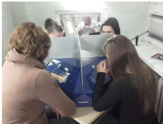
Rys. 1. Pomiar z zastosowaniem olfaktometru dynamicznego TO9
